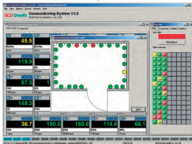
GasCom, графический дисплей для индикации давления в баллонах с функциями аварийной сигнализации и индикацией низкого давления подачи газа
