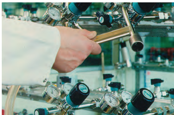
Испытание на утечку гелия
