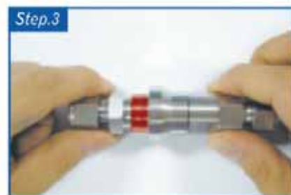
После щелчка соединения готово к использованию
