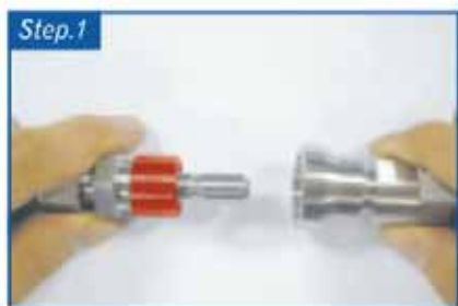
Расположите тело и штуцер на одной оси
